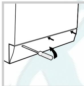
1. снимите нижний плинтус стиральной машины при помощи отвертки (см. рисунок);
